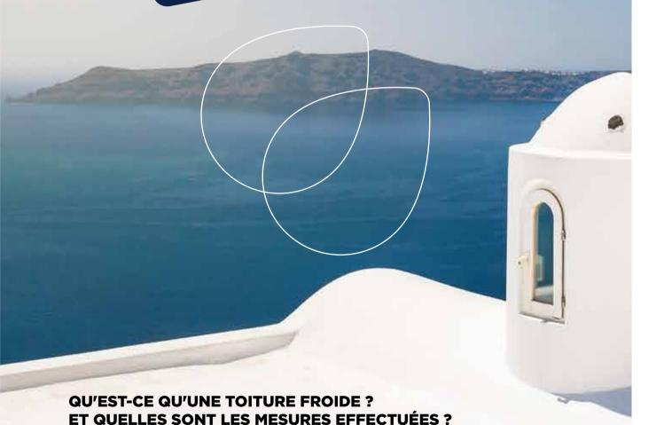
Une toiture froide réfléchit davantage la lumière du soleil et absorbe moins d'énergie solaire qu'une toiture classique. La chaleur solaire est réduite à la surface du toit et la température intérieure du bâtiment diminue : les coûts énergétiques sont inférieurs et les utilisateurs bénéficient de plus de confort. De plus, la durée de vie des bâtiments et des infrastructures (y compris les systèmes de climatisation)
